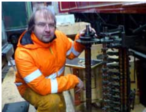
Die Fahrkontrollen müssen umgebaut werden
