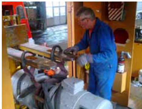
Ausbau des tonnenschweren, defekten Umformers
