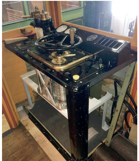
Blick auf den Führertisch mit eingebautem Controller
