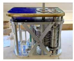
Der Kontroller mit seinen zwei komplexen Schaltwalzen
