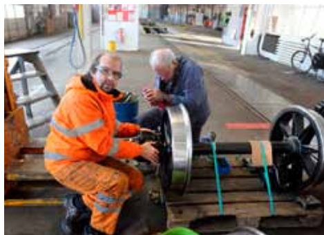
Eine heikle Arbeit: Die Montage der Achslager mit komplett neuer Schmierung.
