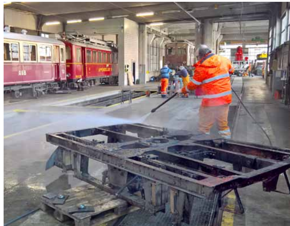
Die Drehgestellrahmen müssen gründlich gereinigt werden
