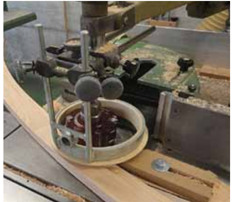
Fräsen der stirnseitigen Dachabschlüsse
