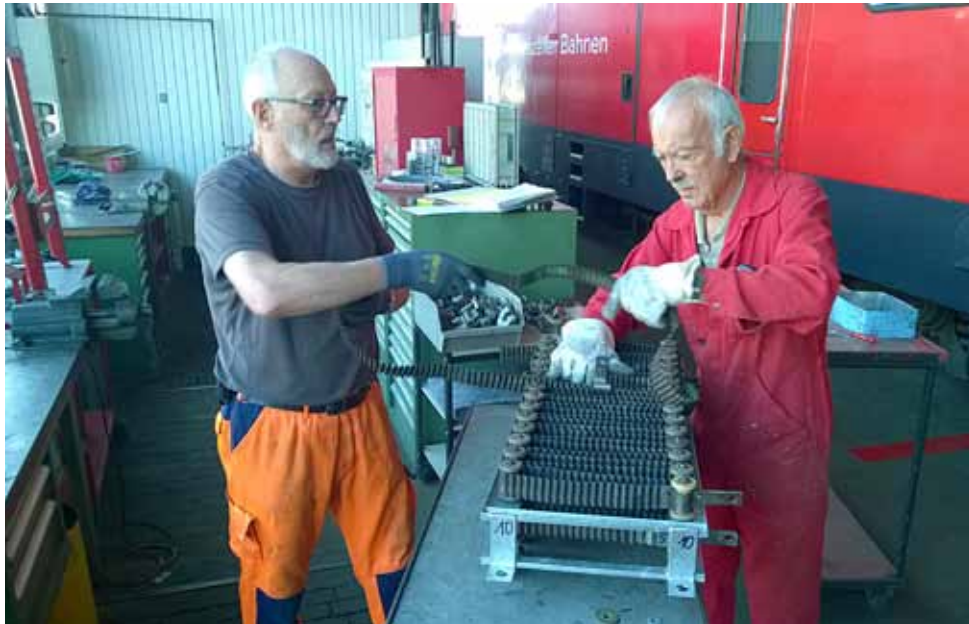
Das Einfädeln der Widerstandsbänder erfordert einiges an Übung
