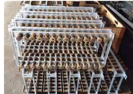
Fertig montierte Rahmen, noch ohne Widerstandsbänder
