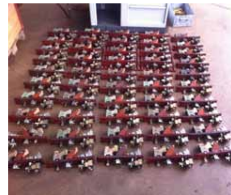
Die 50 Hüpfen (elektropneumatische Schalter) sind für den Einbau bereit, sobald die Apparateschränke geliefert sind
