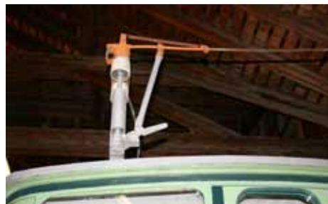
*Zugsammelschiene alt: Die Dachrute in Ruhezustand*
