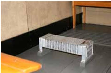
*Ein auf dem frisch lackierten Boden bereits eingebauter Heizkörper. Darüber wird dann wieder ein Doppelbank montiert.*
