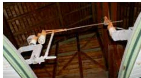
*Zugsammelschiene alt: Die Dachrute wurde geschwenkt und in das Gegenstück eingehängt. Die Wagen sind nun elektrisch miteinander verbunden.*
