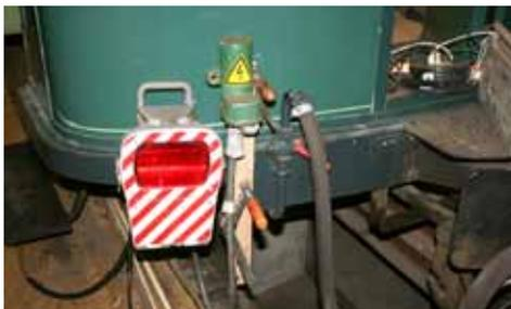
*Stecker und Kabel der Zugsammelschiene wurde provisorisch montiert*
