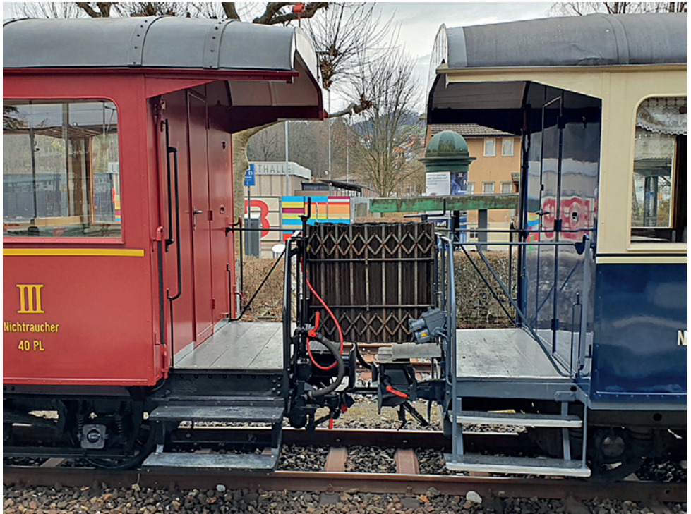
Wagenübergang im restaurierten Zustand
