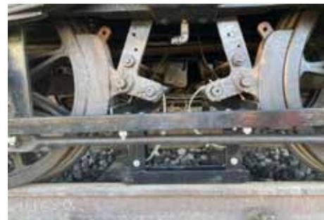
Definitive Version der Magnetschienenbremsattrappen
