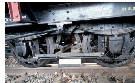
*Das Drehgestell mit der Magnetschienenbrems-Attrappe.*
