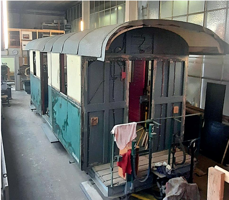
Die Aussenbleche sind wieder montiert und der Dachdecker deckt das Dach neu.
